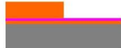
c) deposizione e definizione del \text{SiO}_2
