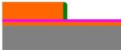
e) Attacco al plasma direzionale del polisilicio
