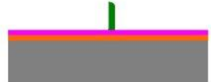
f) Rilascio dei nanofili di silicio
