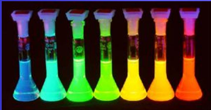
**Altre, come il selenuro di cadmio (CdSe), diventano fluorescenti, emettendo luce di colore differente a seconda delle grandezza delle nanoparticelle**
